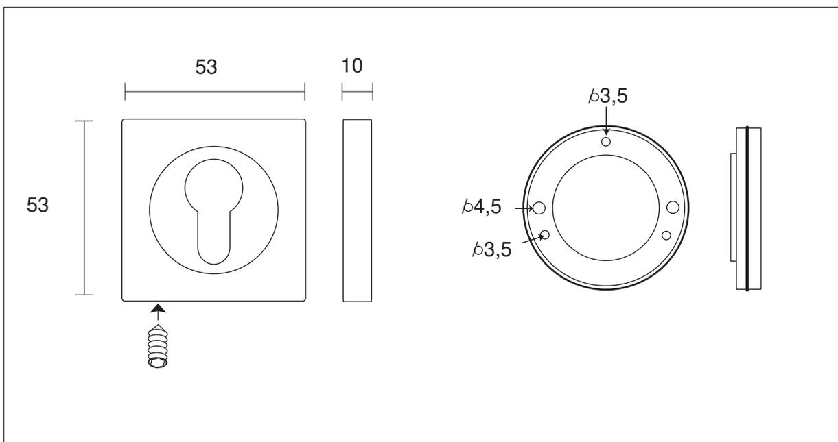
Rosaces de fonction Nickelées mat, clipsée sur la sous rosace en fonte et maintenue par la vis pointeau.
