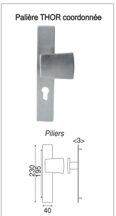
Béquille avec ressort de rappel sur rosace et sur plaque, sauf sur plaque Cylindre avec piliers Carré de 7 et visserie fournis pour portes de 40mm d'épaisseur
