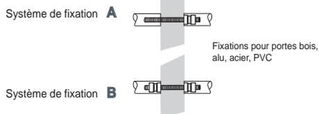
**MONTAGE SIMPLE TRAVERSANT** système de fixation traversante, indiqué par les lettres ST dans nos références
