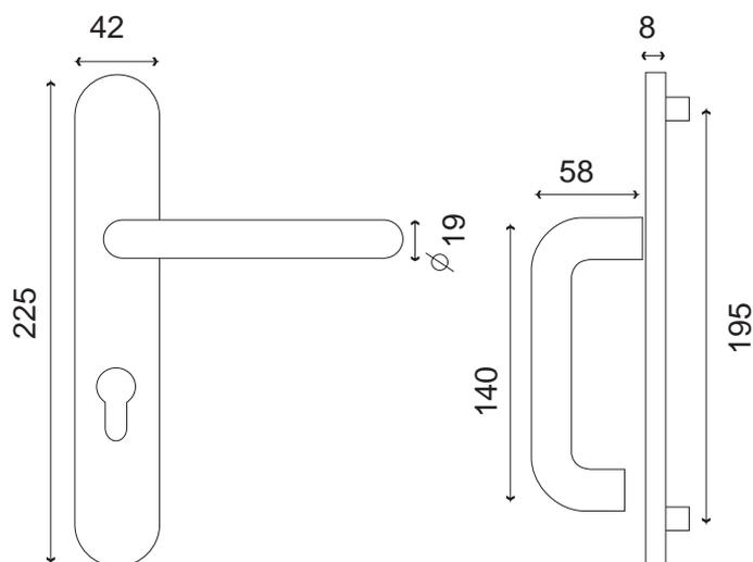
Poignée tubulaire recourbée anti-accrochage sur grande plaque (fixation 195mm)
