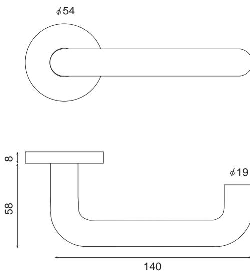
Poignée tubulaire recourbée anti-accrochage montée sur rosace ronde avec ressort de rappel clipsée sur une sous-construction zinguée.
