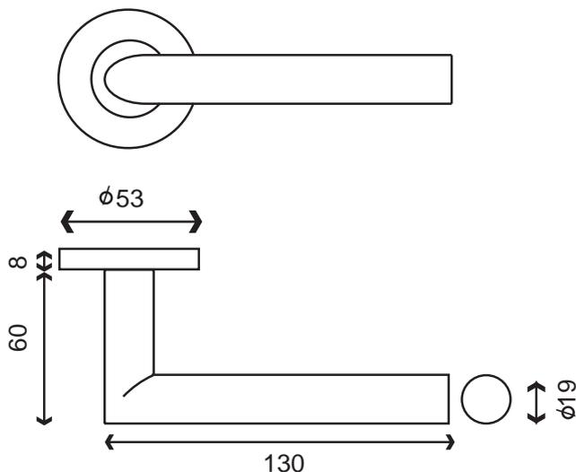
Béquille tubulaire en angle droit montée sur rosace avec ressort de rappel, clipsée sur une sous-construction en inox
