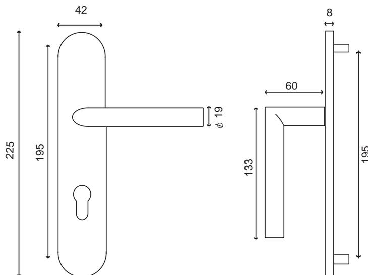
Poignée sur grande plaque (fixation 195mm) sans ressort de rappel, et avec piliers pour un maintien renforcé
