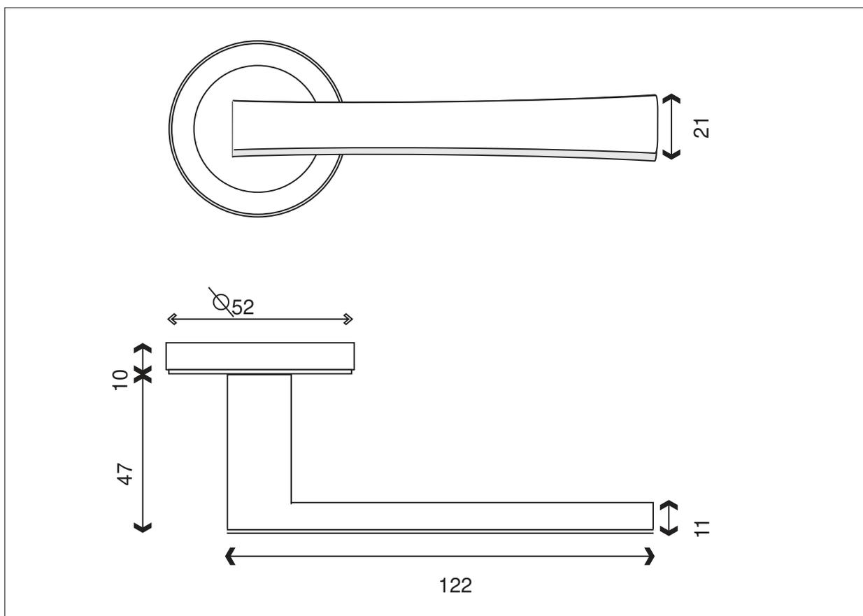
Poignée sur rosace ronde avec sous construction en fonte et ressort de rappel.
