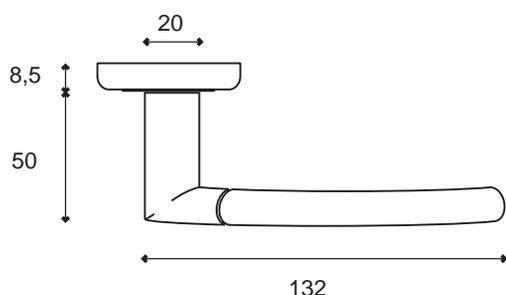
Poignée sur rosace ronde avec ressort de rappel et sous construction en fonte.
