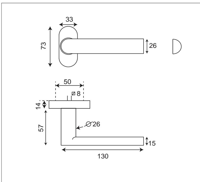
Ce modèle robuste a une sous-construction en fonte et zamak spécialement adaptée aux menuiseries en alu.
