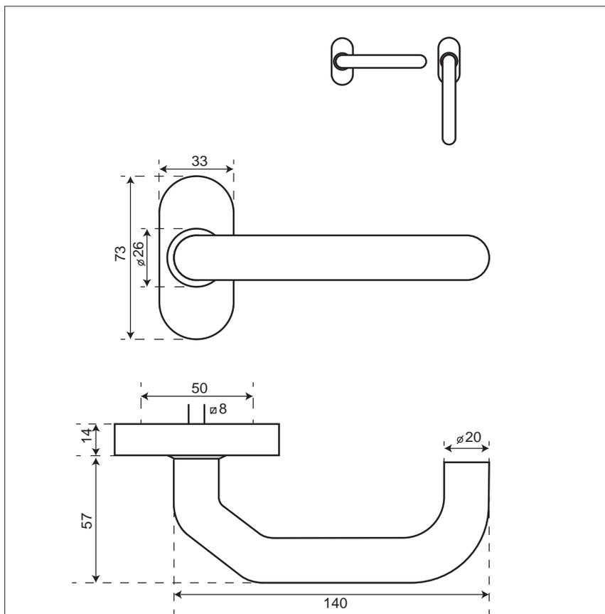
*Ce modèle robuste a une sous-construction en fonte et zamak spécialement adaptée aux menuiseries en alu.
