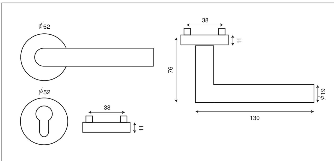
Modèle de bonne facture en inox 304 brossé mat spécialement conçu pour les portes d'entrée, composé d'un ensemble de béquilles sur rosaces rondes + 1 paire de rosaces cylindre, sous-rosaces en nylon noir sur piliers (fixation des rosaces traversante).
