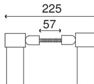
Fixations traversantes par tiges filetées livrées avec le tube
