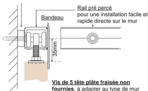
**Vis de 5 tête plate fraisée non fournies**, à adapter au type de mur
