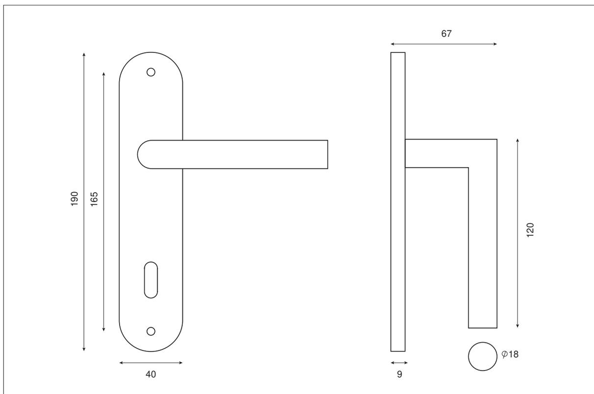
Poignée de porte tubulaire D.18mm avec ressort de rappel, sur petite plaque entraxe de fixation 165mm.
