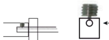
Le carré à chambre doit être monté dans le bon sens pour être bloqué par la vis pointeau et assurer ainsi le bon maintien des poignées.
