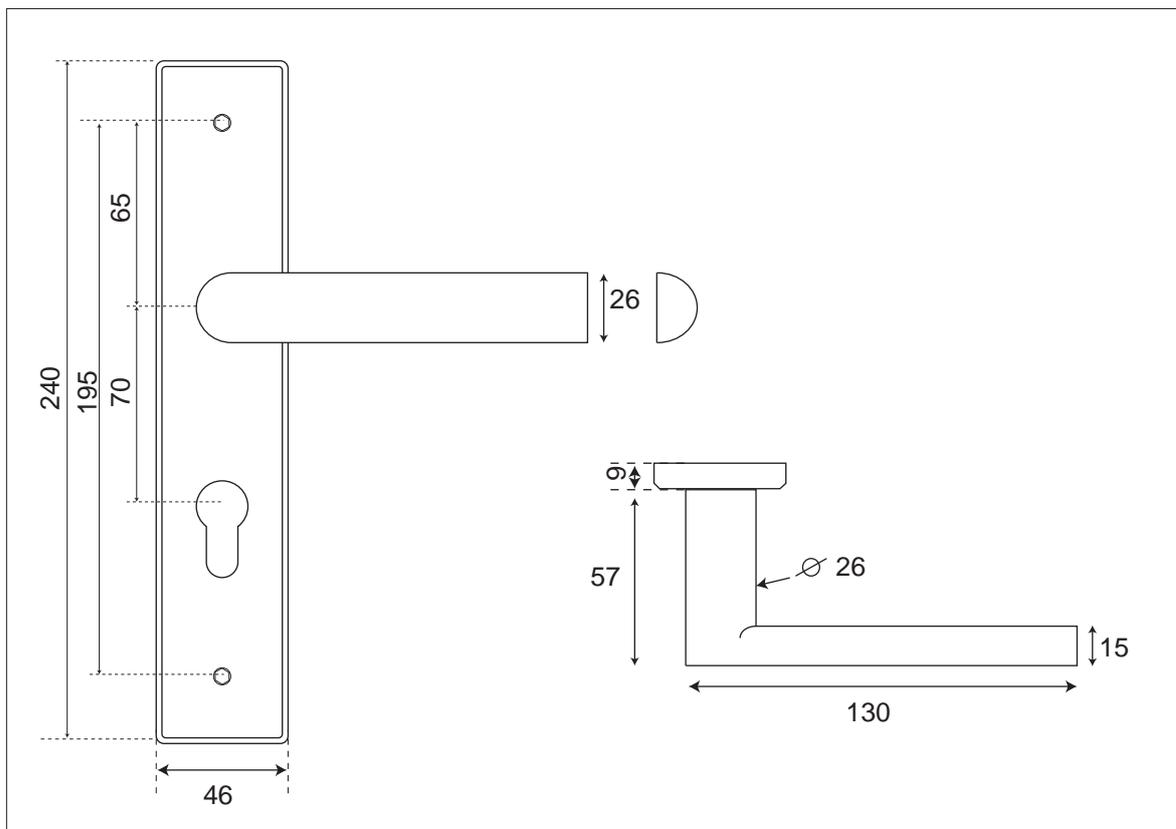
Poignée à section en demi-lune sans ressort de rappel, sur plaque biseautée en fonte massive de 2mm d'épaisseur qui assure la solidité du modèle, renforcée par les vis de 5mm tête 6 pans non visibles pour garantir la sécurité extérieure carré de 7mm, pour portes de 40 à 65mm (à spécifier)
