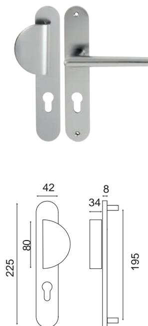
Poignée fuselée montée sans ressort de rappel sur une grande plaque massive avec piliers pour assurer un bon maintien. Carré de 7 x 110 pour portes de 40 à 54 mm d'épaisseur.
