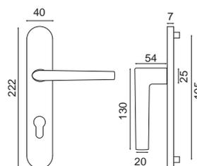
Socoa est un ensemble composé d'une poignée fuselée montée sans ressort de rappel sur une grande plaque massive avec piliers pour assurer un bon maintien.
