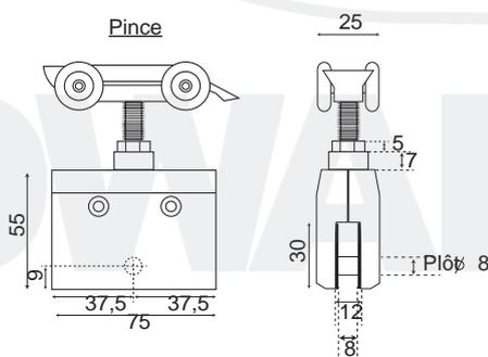
5/ Mettre la porte en place en glissant les boulons des montures à roulettes sur les pinces de fixation de la porte, enfin bloquer les écrous pour prévenir le dégonflage
