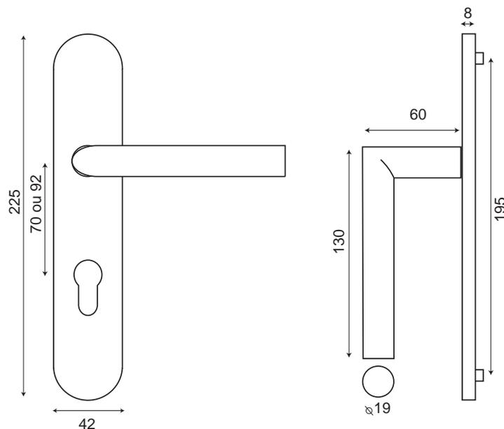
Poignée tubulaire à section ronde montée sans ressort de rappel sur plaque borgne ou cylindre entraxe 70 ou 92 avec piliers pour un meilleur maintien
