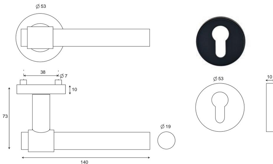
Garniture de porte en inox 304 finition Noire traitée P.V.D. pour plus de résistance aux rayures et à la corrosion.
