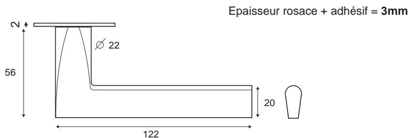
Poignée massive en inox 304 brossé mat , montée sans ressort de rappel sur rosace ronde autocollante fine de 2mm.
